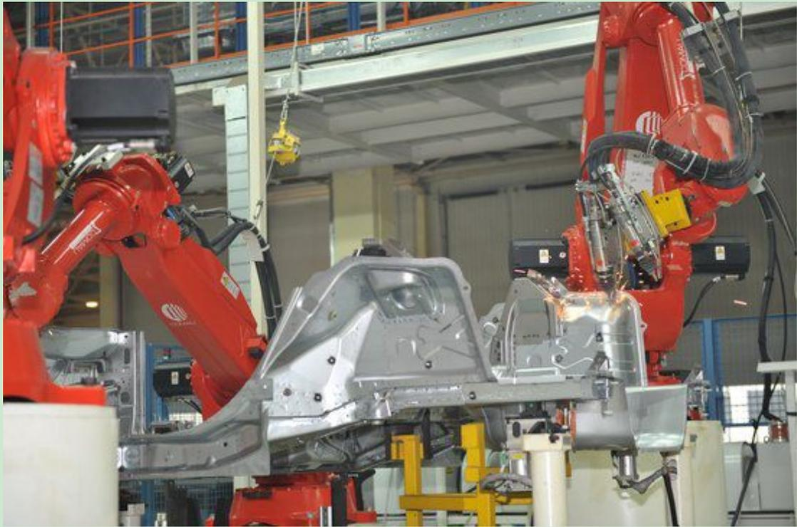
可以说，30年多来集聚的劳动密集型企业为城市发展赚取了“第一桶金”，那么，如今的“机器换人”将成为城市新一轮工业革命的重要切入点和增长点。配有激光加工设备的工业机器人，功能包括激光焊接、激光切割、激光复合焊、远程激光焊接切割及激光焊缝跟踪功能包等等。
